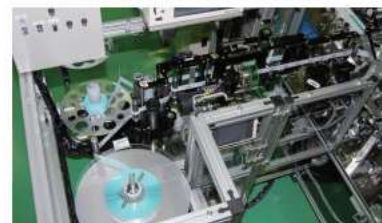
胴貼りユニット(印字・印字検査)
