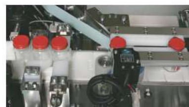
3ポジション支持ローラー方式ラベル貼付機構
