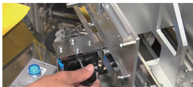
ラベル寸法誤差調整機構
