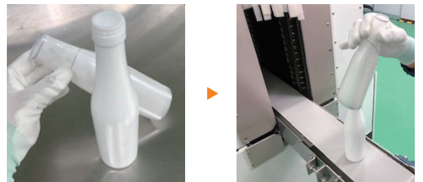
ラベルを被せ、自製製の機械で加工します
